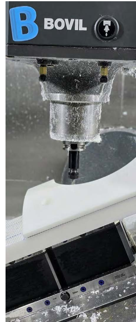
Emne til olie- og gasindustrien fræst på Bovils 5-aksede simultanfræser.
