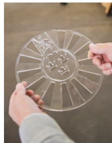
Laserskæring af logo i klar PMMA (akryl). Opido kan bearbejde PMMA i op til 30mm tykkelse i to laserskæremaskiner, 2x3m i størrelse.
