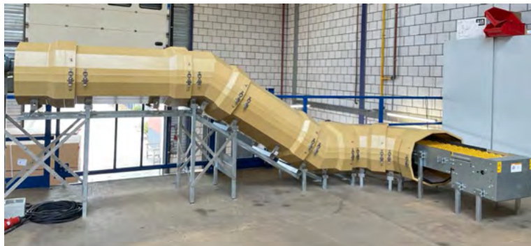
Afdækning til transport af æg produceret af TPI Polytechniek B.V.
