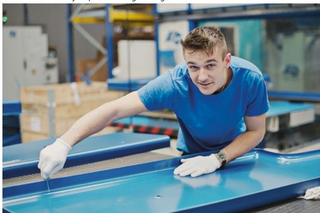
Andrezej Filipiak ved afgratning af vakuumformet emne.
