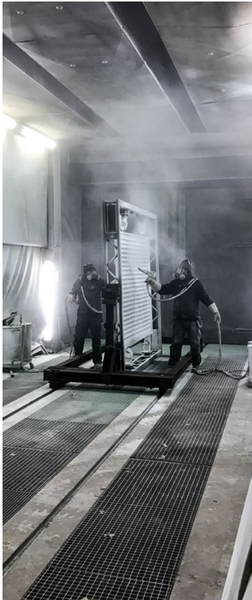
Accoat – belægning med Accoshield pulver
