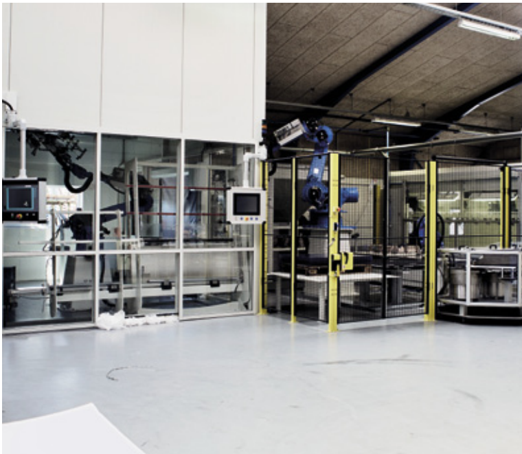
Automatiseret produktionslinje til transparente vakuumbremmede plastemner i støvfrit miljø
