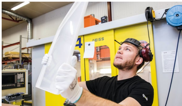
Emil Nilsson kvalitetstjekker et acryl-panel, som anvendes i videokonference systemer. Emnet er fremstillet hos Opido Plast AB i Sverige.
