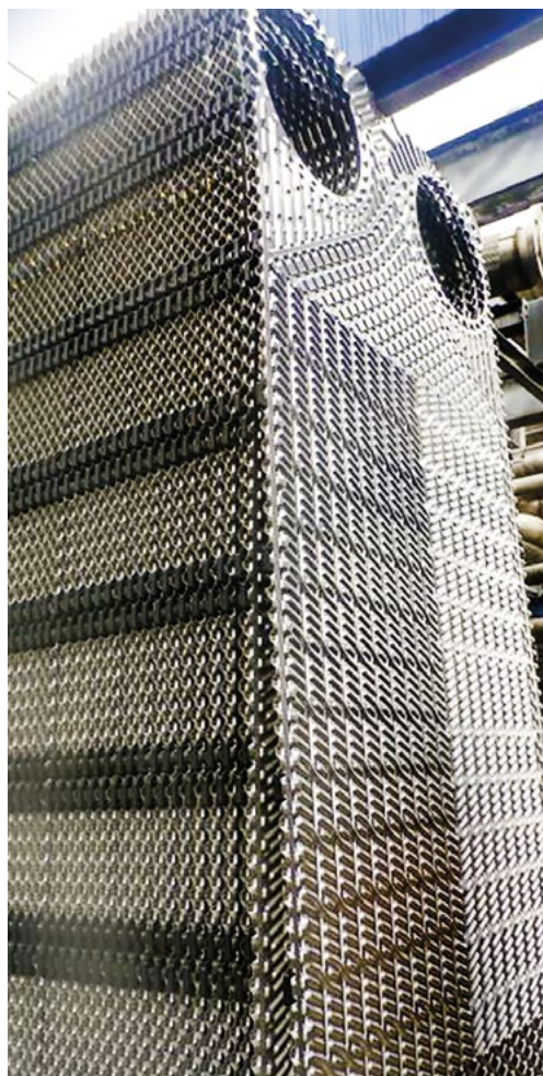
Pladevarmevekslere belagt med Accolan opnår større effektivitet og får øget levetid.
