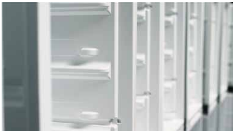
Vakuumformning, inderboks til køleskabe
