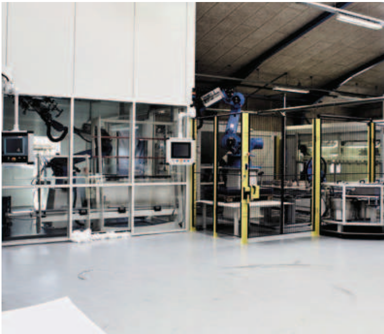
Automatiseret produktionslinje til transparente vakuumformede plaster i støvfrit miljø
